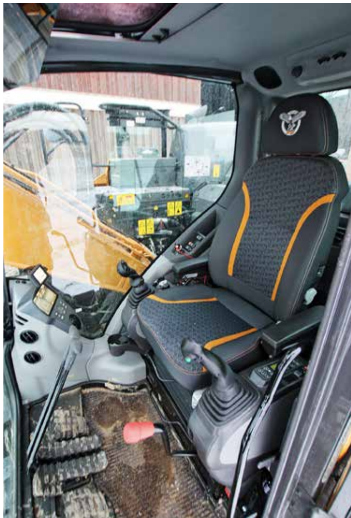
↑ Casen ohjaamo on varsin hiljainen. Lämmitetty ilmaistuin on vakiovaruste. Säilytystilat ovat kuitenkin rajalliset.
