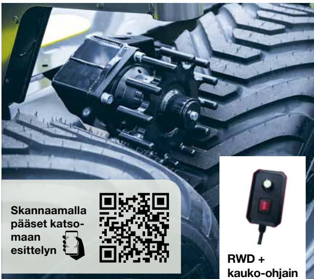
PALMS RWD (rullavetolaite pyörien välissä)
