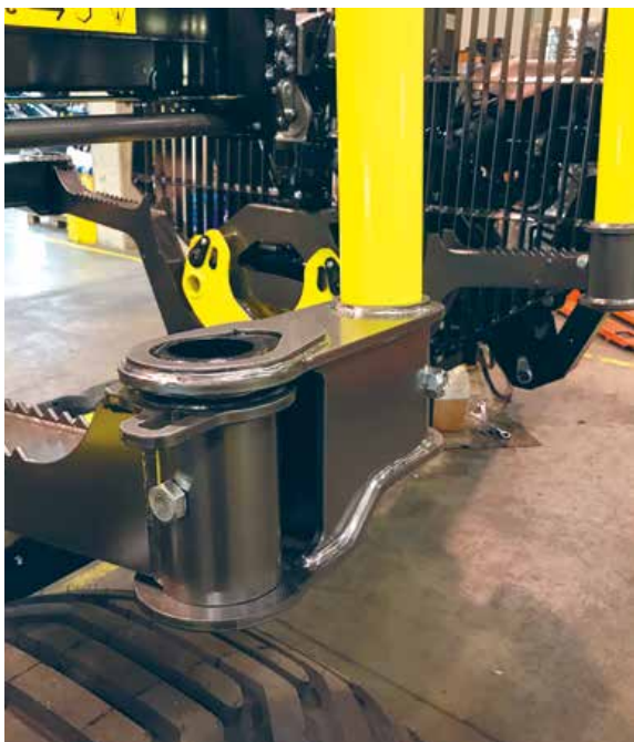
Kuormausalueen levennys kuormatraktortyyppisille tuille
